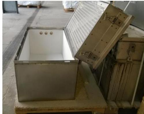
Cargo-Transportbehälter für Lithium-Batterien im Luftverkehr
