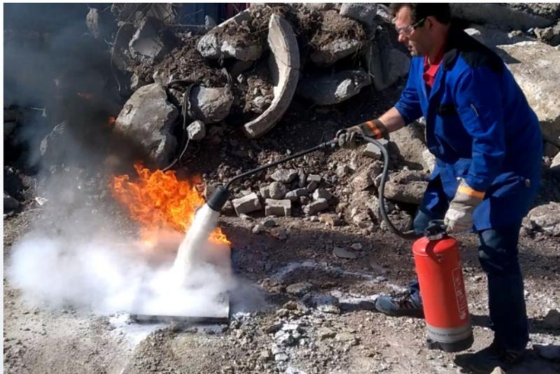
Löschversuch eines Benzin-Diesel-Petroleum-Gemischs mit einem Metallbrandlöscher gefüllt mit Extover® Feingranulat
