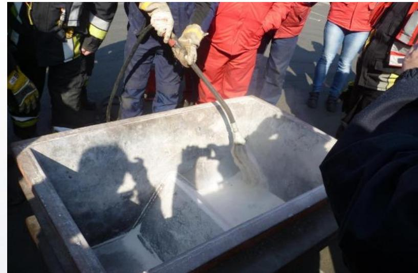
Löschversuch eines Magnesiumbrandes mit einem Metallbrandlöscher mit Extover® 0,1-0,3 mm Feingranulat Füllung
