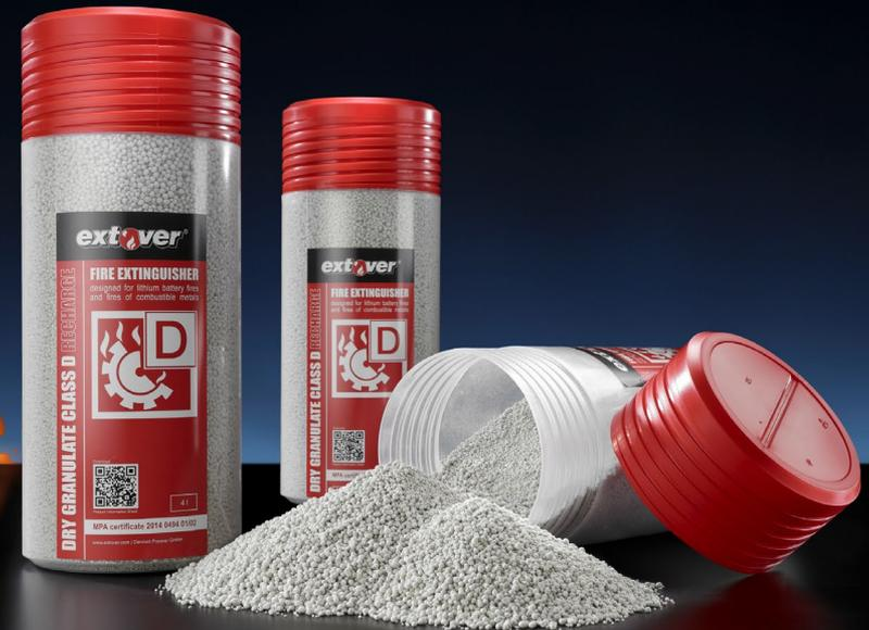
Durch Abdecken der Brandlast mit Extover® Granulat wird Sauerstoff verdrängt und vom Brennstoff getrennt. Wie Glas schmilzt Extover® ab einer gewissen Temperatur. Das Granulat nimmt dabei viel Wärme in Form von Schmelzenergie auf, kühlt damit den Brand ab und bildet gleichzeitig eine undurchlässige Hülle über der Brandlast. Eine Reaktion mit Sauerstoff wird effektiv verhindert.
